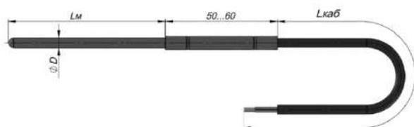
Термопара с кабелем «Б», с кабельной монтажной частью «К»
