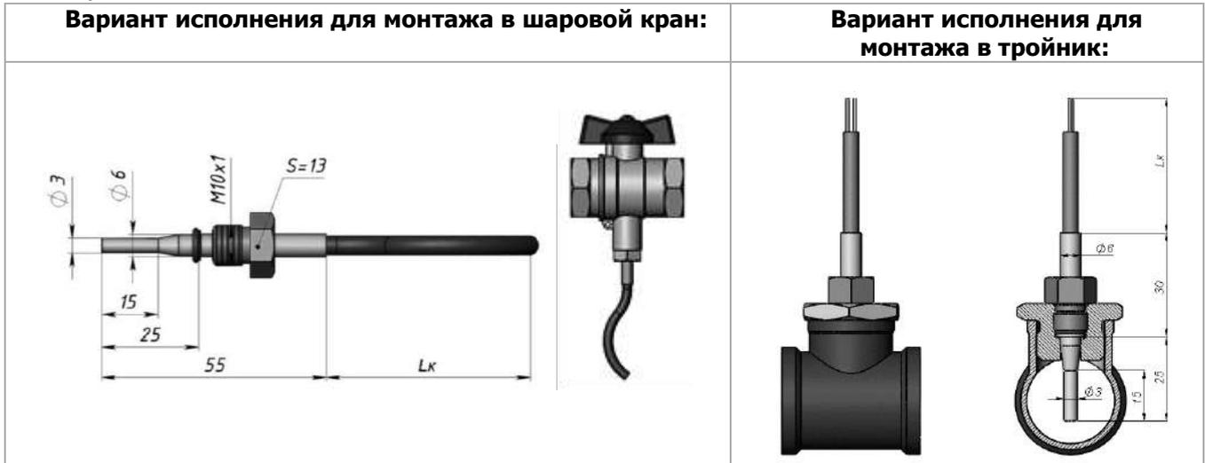
Комплекты термопреобразователей с кабелем данной модификации могут поставляться как отдельно для Ду 15-32, так и с шаровыми кранами DN 15, PN 1,6 МПа.
