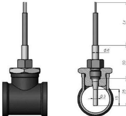
*Пример записи условного обозначения датчиков температуры (ТС-Б) для монтажа в шаровый кран (тройник)*
