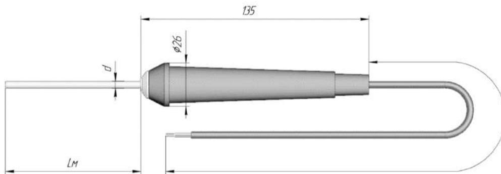
Рисунок 5.5 – Щуп для измерения температуры сыпучих материалов\*
