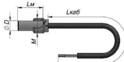
Термопреобразователь с кабелем «Б», с подвижным штуцером, конструкция «втулка с пазами» «ПШпв»
