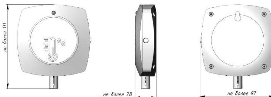
Рисунок 5.3-Прибор измерительный ПИ-002/1М,М.Д
