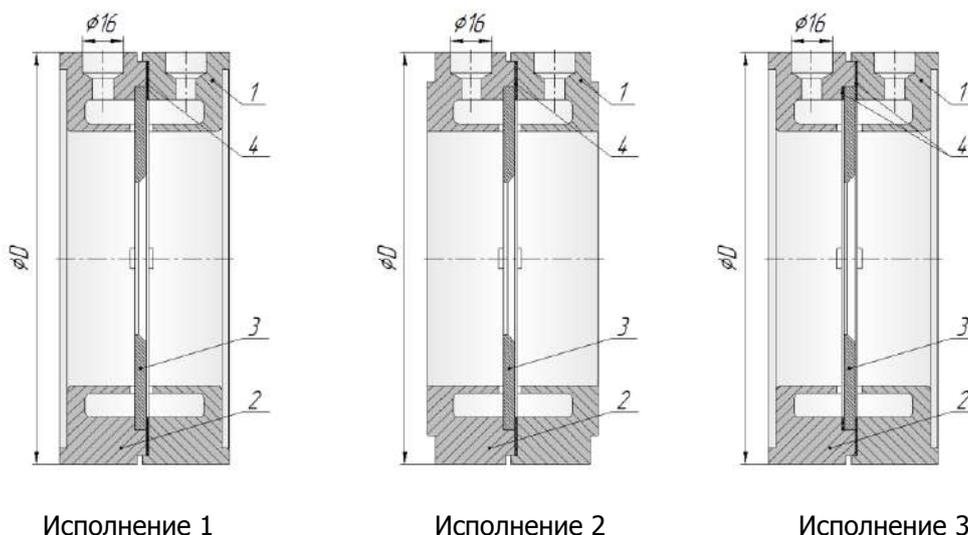
**Поз.1** – Корпус минусовой камеры; **Поз.2** – Корпус плюсовой камеры; **Поз.3** – Диафрагма;
