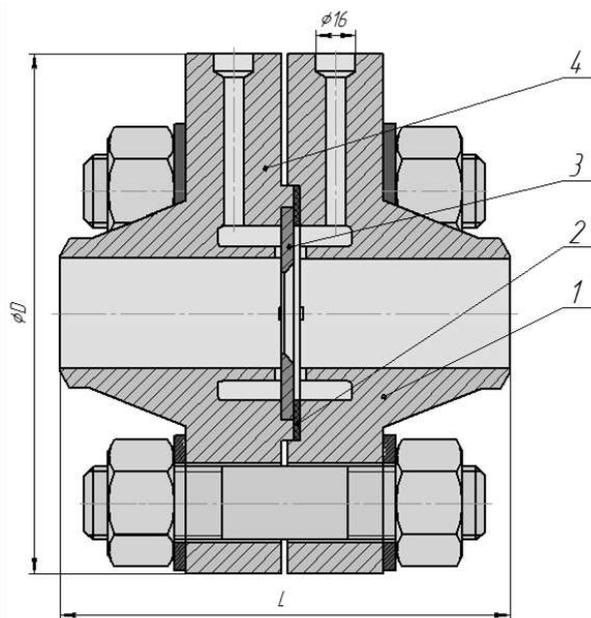
**Поз.1** – Корпус минусовой камеры; **Поз.2** – Прокладка камерная (паронит ПОН-Б);
