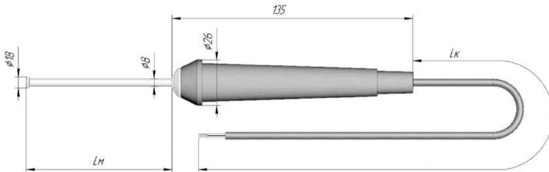
Рисунок 5.6 – Щуп для измерения температуры поверхности\*
