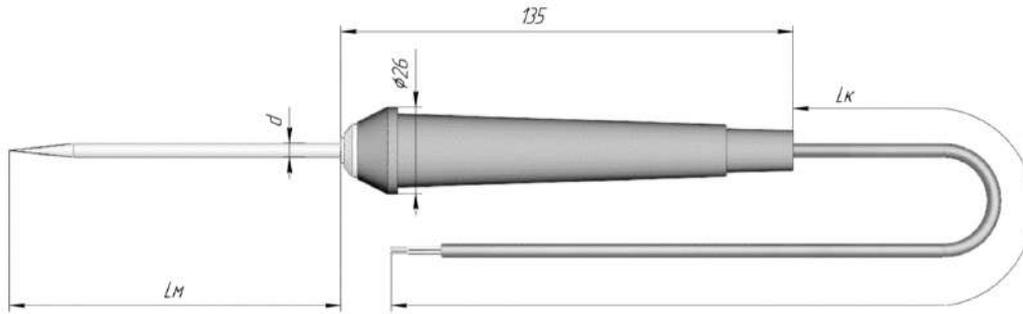
Рисунок 5.4 – Щуп для измерения температуры продуктов питания\*
