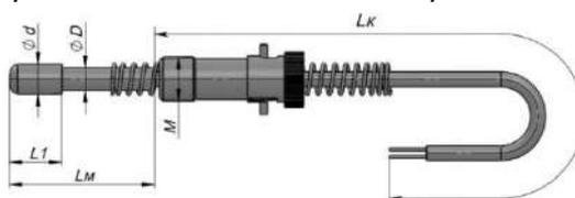
Термопара с кабелем «Б», с погружной монтажной частью «П», с байонетным разъемом «Бр»
