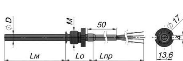
Термопреобразователь с проводами «А», с подвижным штуцером, конструкция «штуцер с пазами» «ПШп»
