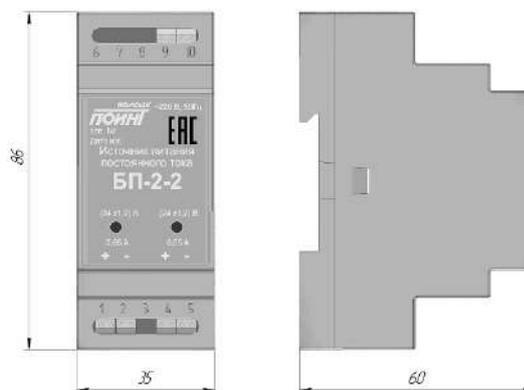
Рисунок 6.1 – Источник питания постоянного тока БП-2 двухканальный
